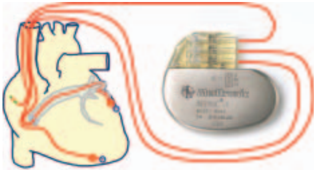
Рис. 2. Схема расположения электродов в сердце и их соединение с ЭКС, для осуществления ресинхронизации сердца.
